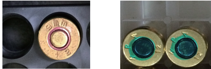
圖 1 試射用 9mm × 19 子彈：205 兵工廠子彈（左）及警用子彈（右）
